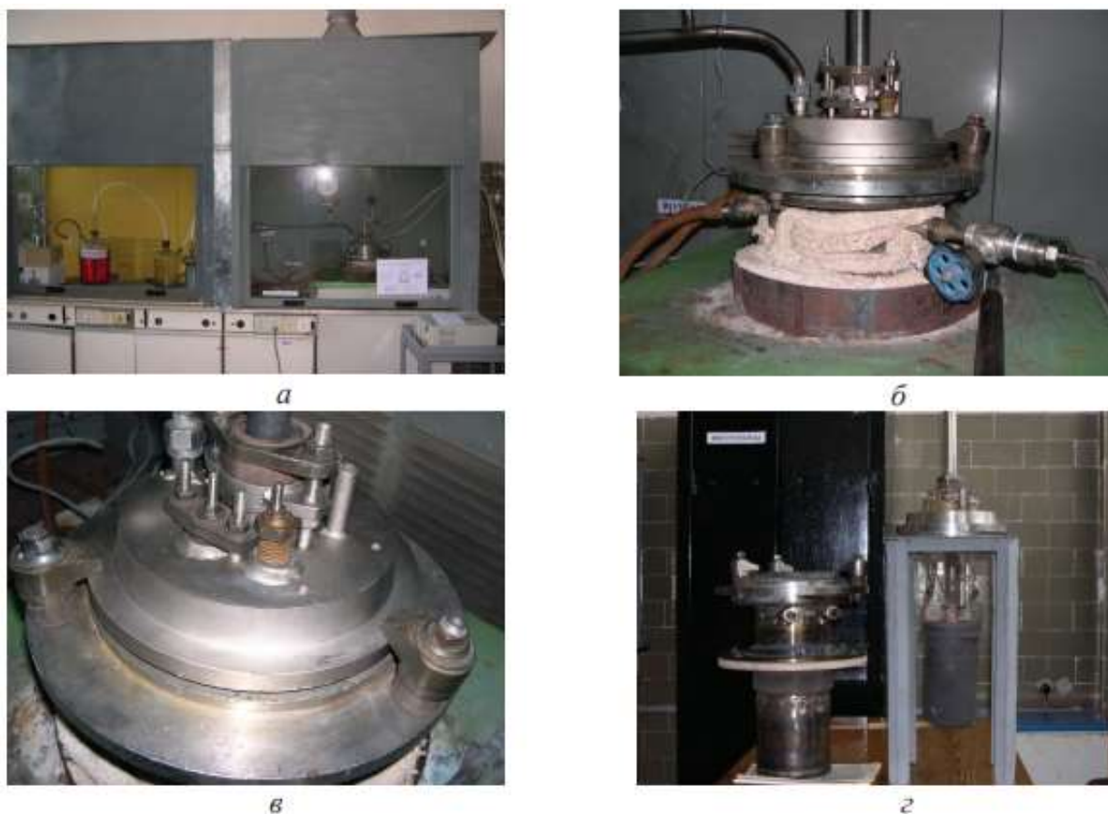
а - общий вид установки; б - герметичный электролизер; в - никелированная крышка электролизера; г - графитовый тигель
